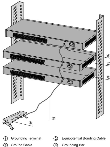
Figure 3-3 Equipotential Bonding
